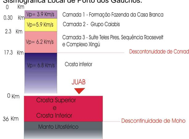
Figura 5 - Modelos 1-D e da Função do Receptor.
